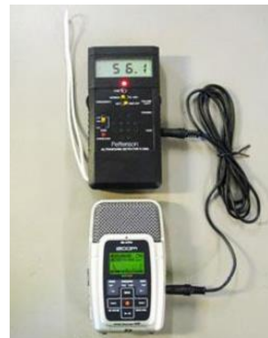
Figure 285 : Illustration d'un D240X et de son enregistreur
